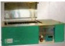
Edelstahlbad, Temperaturbereich +25 ... +100°C, mit mikroprozessorgesteuerten Temperaturregler ±0,6 K, digitaler Temperaturanzeige, mit Schrägdeckel, Trockenschutz, Schüttelfrequenz 20...200 pro min, Schüttelhub 16 mm, Sicherheitsklasse 1 nach DIN 12876. Der SKF 20 gehört zum Lieferumfang
